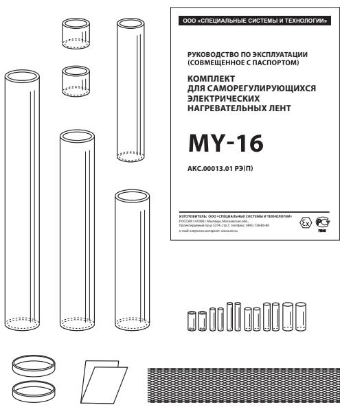
Комплект MY-16 предназначен для соединения саморегулирующихся электрических нагревательных лент марок VM, VL, VR (до 125 °C) с оболочкой из термопластичного эластомера и фторопласта. Максимальная температура воздействия 125 °C. Комплект MY-16 включает в себя термоусаживаемые трубы на основе полиэтиленовой композиции, припой, медную плетенку, фоторадиостабилизированную ленту.
