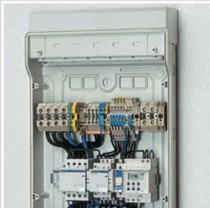
Увеличение внутреннего пространства при помощи DIN-рейки по всей ширине корпуса. Используется для установки неуправляемого оборудования. Установочная глубина 72мм, расстояние между рядами 125 или 150 мм.
