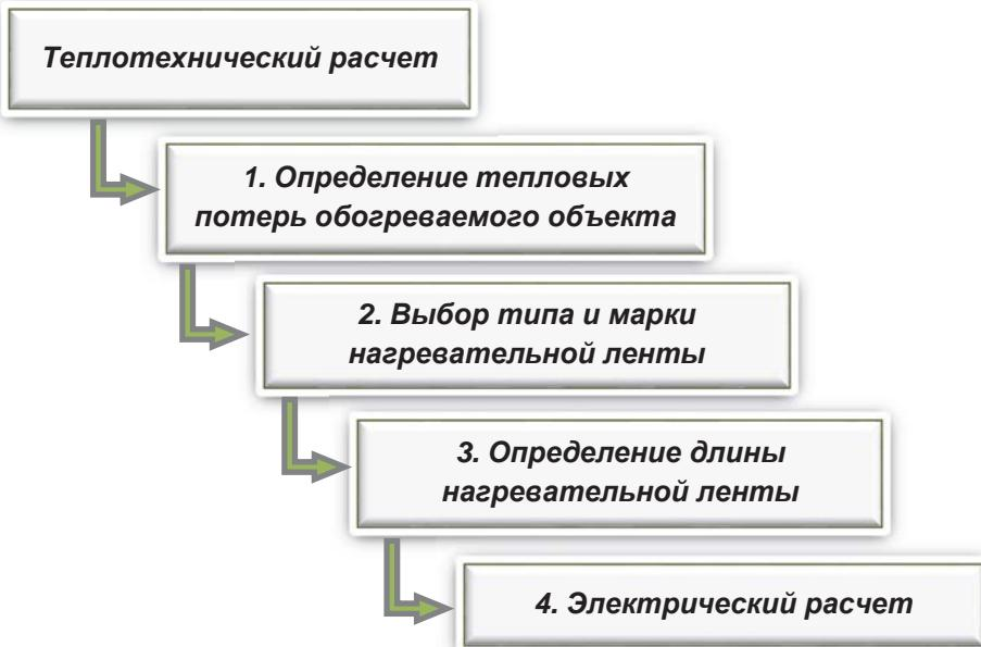
Выполнить теплотехнический расчет трубопровода или резервуара и определить необходимую длину нагревательной ленты возможно несколькими способами:
